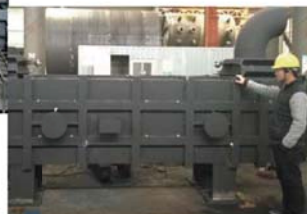
丁辛醇装置含丁醛、丁醇、氢气尾气催化焚烧项目设计温度650℃，冷侧尾气压降<1.5KPa热侧尾气压降<2KPa设备重量~8吨。
