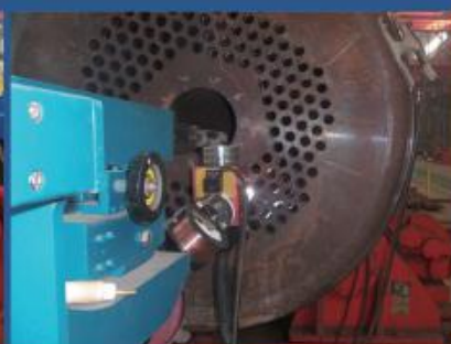
2.内孔焊焊接技术
