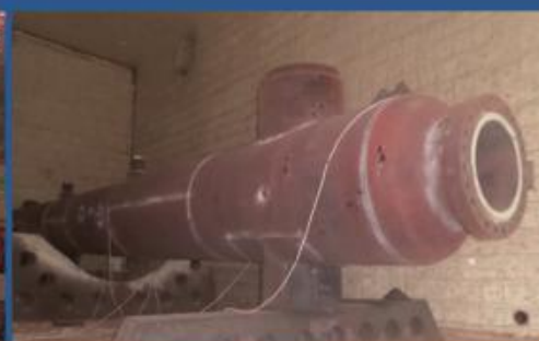
3.内孔焊整体热处理技术
